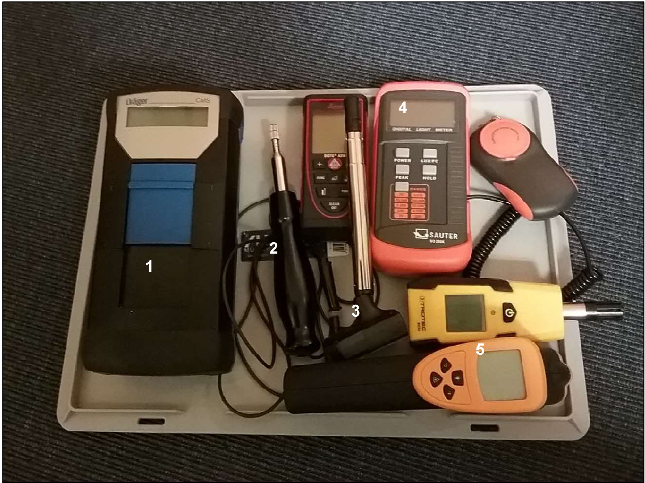
Abbildung 33: für die Risikoanalysen verwendete Messtechnik: Dräger CMS-Analyse-Gerät (1) mit Sonde (2) und CO 2 -, H 2 S- und NH 3 -Analyse-Chips (nicht dargestellt), Testo 405-Thermo-Anemometer (3), SAUTER Luxmeter (4), TROTEC Thermohygrometer BC06 (5)
